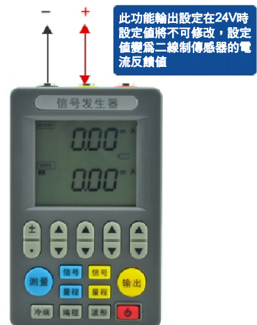
兩線制變送器 測試方法
