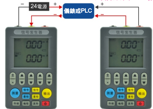
兩線式變送器模擬器接法
