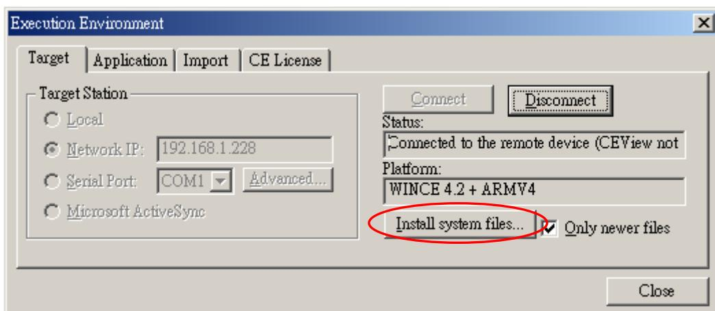
Step6: 執行 Install system files. 下載 Bin , Drv 資料夾。
